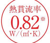
たてすべり出し窓+FIX連窓ダブルLow-E
